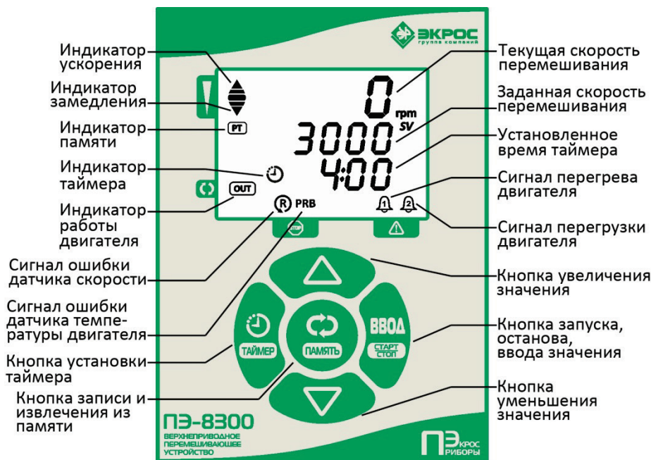
Рисунок 2 - Панель управления
